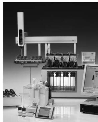
**Le système de mesure de viscosité PVS dans la version autoéchantillonneur VAS1/4 avec système de pesage et de dosage et bloc d'agitateur magnétique chauffable**
