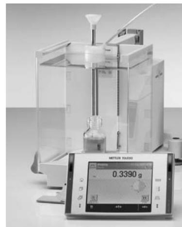
**Balance METTLER TOLEDO XP204 avec entonnoir de remplissage et tube capillaire de dosage de solvant intégré**
