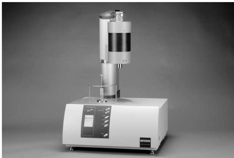
**NETZSCH STA 449 F1 Jupiter® Analyse Thermique Simultanée (four levé et pivoté sur le côté).**
