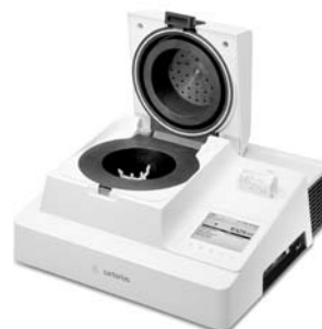
L'analyseur d'humidité à microondes LMA200PM offre une alternative au contrôle rapide at-line du taux d'humidité dans les zones de production ou de réception de marchandises.
