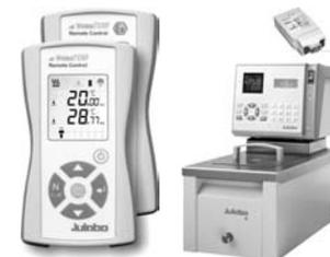
**Les composants de «WirelessTEMP» se laissent combiner suivant l'utilisation. Ici, p.ex. la commande «Remote Control» et le «transmitter» pour l'appareil.**
