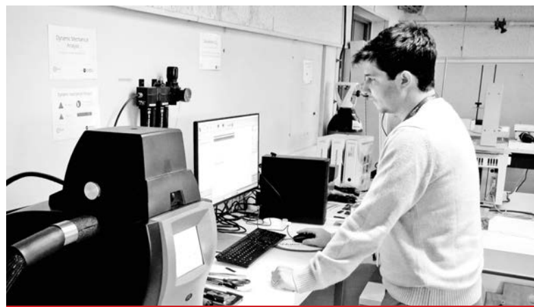
Caractérisation d'un échantillon vitrimère par analyse mécanique dynamique - © CNRS
