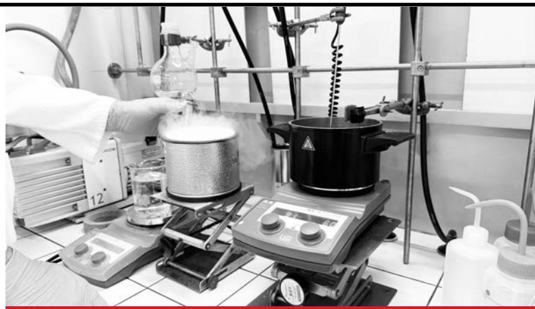
Refroidissement du mélange réactionnel dans l'azote liquide - © Fanny Weiss
