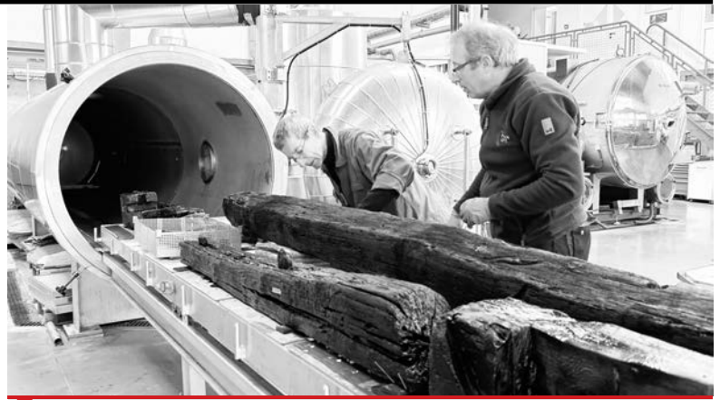
▼ Lyophilisation d'éléments de l'épave de Villenave-d'Ornon - © ARC-Nucléart
