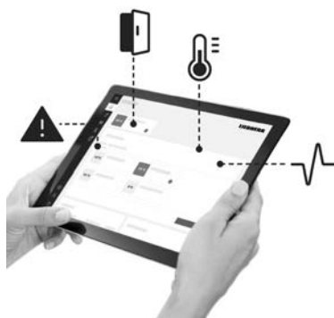
La solution digitale SmartMonitoring Liebherr fournit une traçabilité complète de la température à l'intérieur de l'appareil
