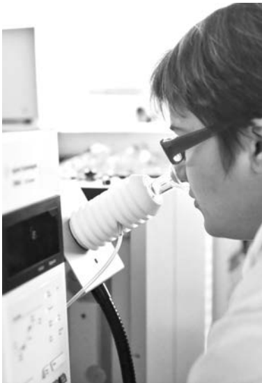
La chromatographie en phase gazeuse couplée à l'olfactométrie est une technique de choix pour l'identification des composés odorants du vin - © ISVV
