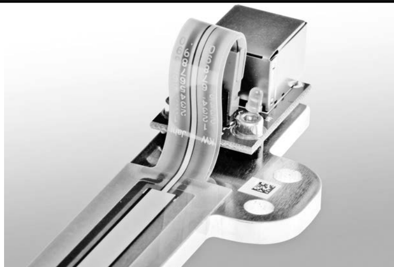
Sensofoil – capteur ultra plat - © Hoffmann + Krippner
