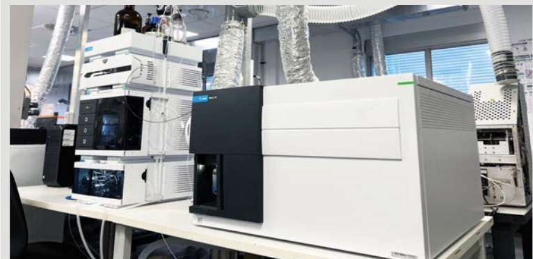
LC-MS-MS (Chromatographie liquide) dans notre laboratoire de Lyon, cette machine permet d'analyser la présence des PFAS dans l'eau - © ALS France
