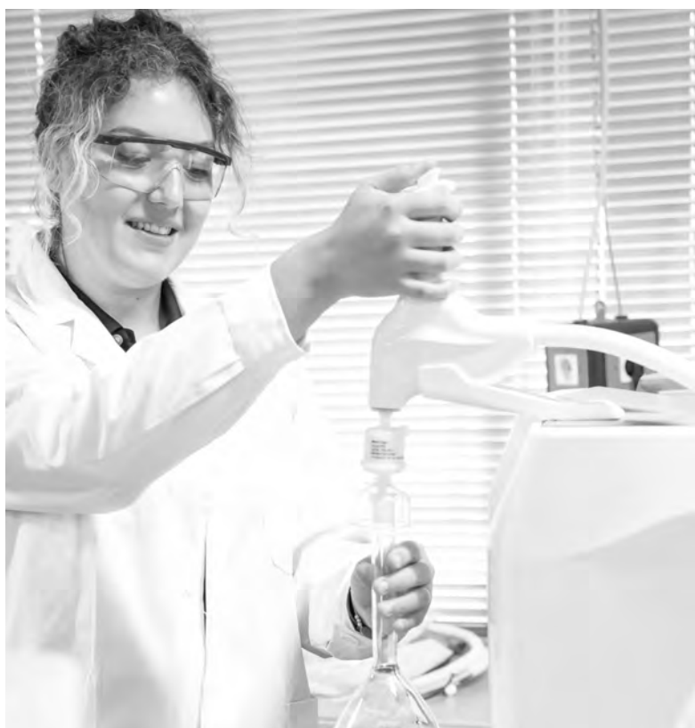
Après séparation chromatographique, on ajoute un réactif qui réagit avec les acides aminés et forme des dérivés chromophores stables. (avec l'autorisation de Membrapure)
