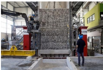
Photo d'un essai réalisé au sein du four VULCAIN - Equipement CSTB
