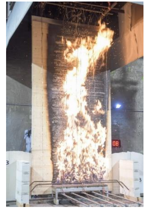
Photo d'un essai - Incendie de façade bois
