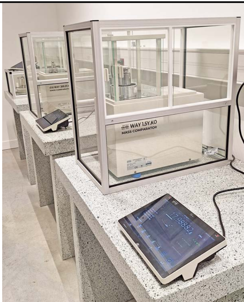
Présentation du laboratoire avec quelques uns des comparateurs Radwag acquis par LaboMasse
