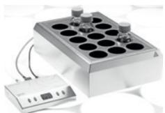
Les blocs chauffants sont proposés en 2 versions DRYBATH 15-100 15 postes (ø 57,5 mm, profondeur 48 mm, distance 65 mm), version idéale pour bouteilles de laboratoire 100 ml et béciers de 150 ml (forme haute) et DRYBATH 15-250 15 postes (ø 71,5 mm, profondeur 78 mm, distance 84 mm), version idéale pour bouteilles de laboratoire 250 ml et béciers de 400 ml (forme haute).
