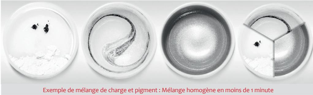
Exemple de mélange de charge et pigment : Mélange homogène en moins de 1 minute
