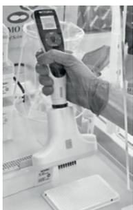
Les chercheurs du Département de Biomédecine de l'Université de Bâle utilisent VOYAGER, la pipette électronique à écartement réglable des pointes d'INTEGRA, pour optimiser l'efficacité de leurs procédures et réduire les erreurs de pipetage.
