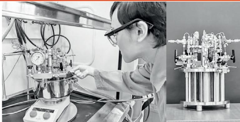
Réacteur haute pression parallèle Multicell sur mesure en cours d'utilisation.
