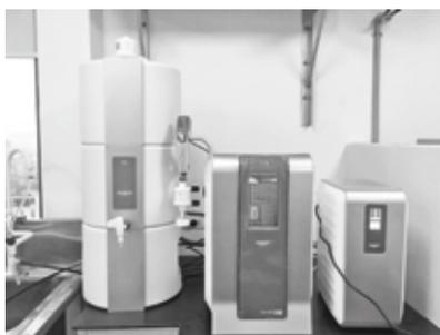
**DUO-i (Exclusivité) remplace l'assemblage osmoseur, cuve, polisseur, et répond aux besoins spécifiques des laboratoires pour des applications très variées.**
