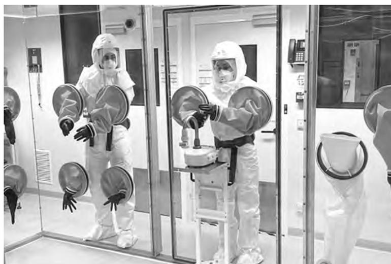
**Banc d'essais de 20m<sup>3</sup> : on observe deux manipulateurs en train de réaliser la collection d'un échantillon d'air de l'atmosphère contaminée générée dans le banc d'essais. Leurs mains sont dans des gants qui leur permettent de manipuler à l'intérieur de ce dernier sans rupture du confinement pour la sécurité des manipulateurs et de l'expérimentation - © VirexpR**
