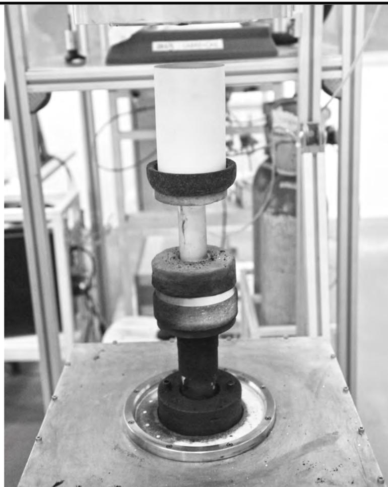
Creuset du four pilote thermogravimétrique semi batch. Il permet le suivi de la masse et l'analyse en ligne des gaz formés lors de la vapo-thermolyse d'échantillons de plusieurs dizaines ou centaines de grammes. Introduction de l'échantillon par un sas et préchauffage du gaz d'atmosphère jusqu'à 200°C - @ IMT Mines Albi
