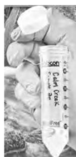
Les tubes à centrifuger MetalFree® Labcon assurent que les teneurs en métaux les plus fréquents et en éléments pouvant interférer avec vos expériences, sont inférieures à une partie par milliard (< 1 ppb).
