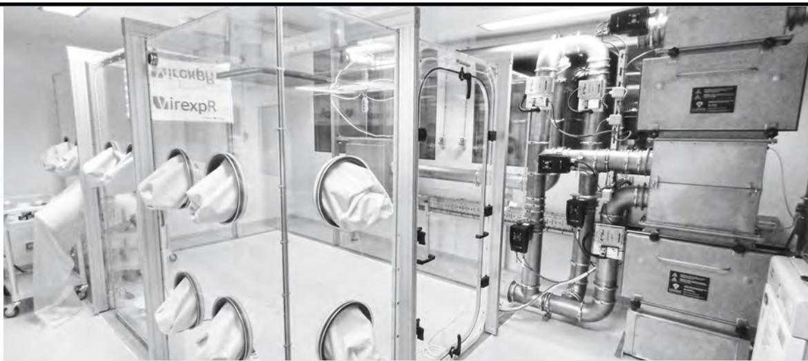
**Banc d'essais complexe de grand volume comprenant une enceinte hermétique de 20m<sup>3</sup> et une centrale de traitement d'air permettant de caractériser les performances des dispositifs de traitement de l'air dans des conditions expérimentales mimant différents environnements réels d'utilisation - © VirexpR**
