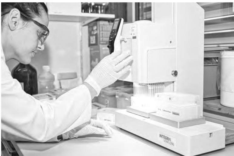
Microsynth utilise des pipettes VIAFLO 96 pour préparer des échantillons pour l'isolement de cfDNA (Photo avec l'aimable autorisation de Microsynth)
