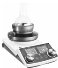
L'agitateur magnétique Hei-PLATE Mix 'n' Heat Expert permet une utilisation intuitive avec un affichage pour chaque fonction principale (mélanger et chauffer). L'utilisation se fait à travers deux boutons-poussoirs rotatifs avec des anneaux LED pour l'identification facile des fonctions actives. Les minuteries séparées pour les fonctions Chauffer et Mélanger créent une certaine flexibilité et vous permettent d'optimiser le pilotage de vos processus.
