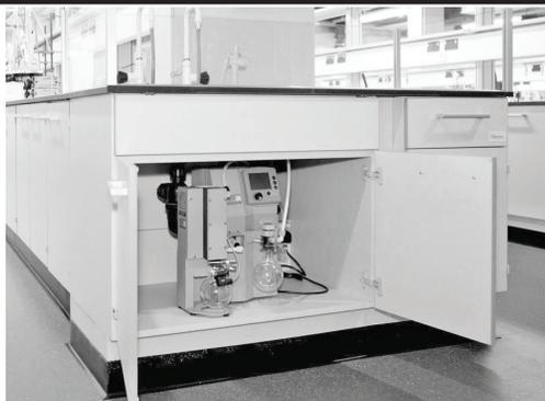
Une pompe de réseau équipée d'un condenseur de vapeur Peltronic alimente en vide toute une rangée de paillasses, sans qu'un raccordement d'eau de refroidissement ne soit nécessaire.
