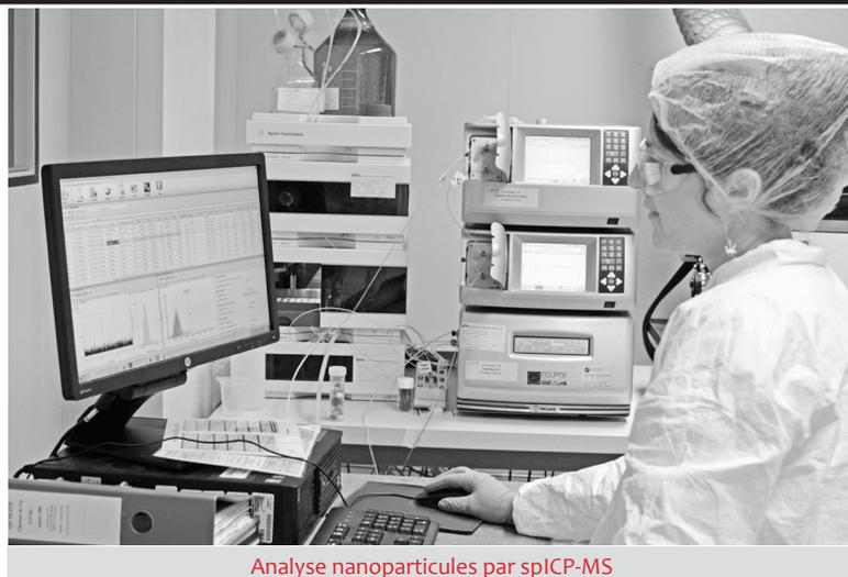
Analyse nanoparticules par spICP-MS
