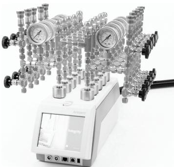
Asynt a développé un nouveau système de réacteurs haute pression qui s'intègre directement à sa station de réaction Integrity 10, permettant aux scientifiques de réaliser en parallèle jusqu'à 10 réactions indépendantes sous pression (jusqu'à 100 barg).
